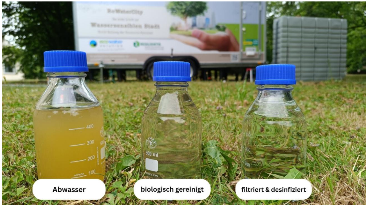
Abbildung 1 Wasserqualität der dezentralen Kläranlage: vom unbehandelten Abwasser auf der linken Seite über „biologisch gereinigt“ bis hin zum kristallklaren „filtriert & desinfiziert“
